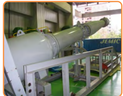
計器用変圧器
