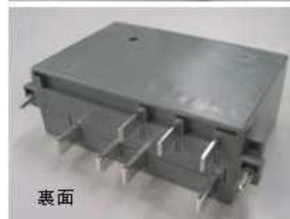
図2 電力量計ユニットの外観
