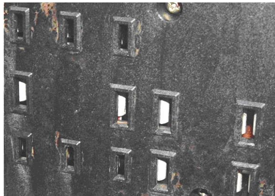
図14 砂塵試験実施後の砂塵付着状況
