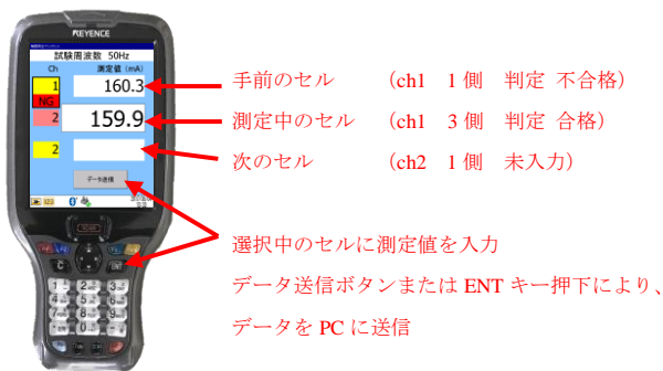
図 4 始動電流の測定
