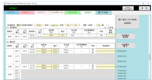
図 3 試験電源装置の測定
