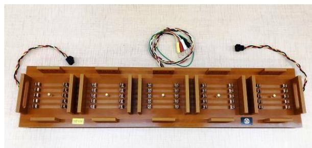
図2 結線器の外観（新型計器5台に対応）
