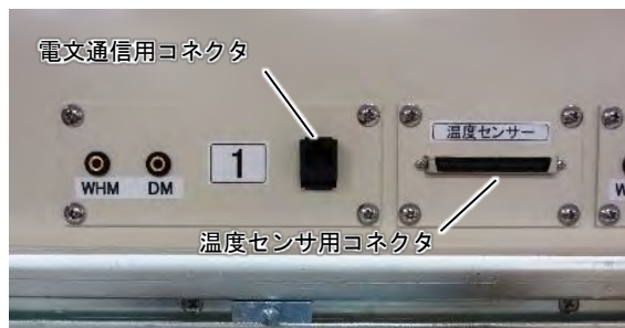
図4 掛台部上部の接続コネクタ
