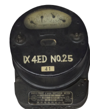
大正時代に使われていた電気メーター
