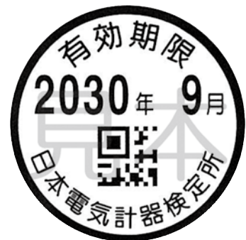
▲電気メーターに貼られているラベル* 写真のラベルは、2030年9月まで使用可能であることを示しています。
