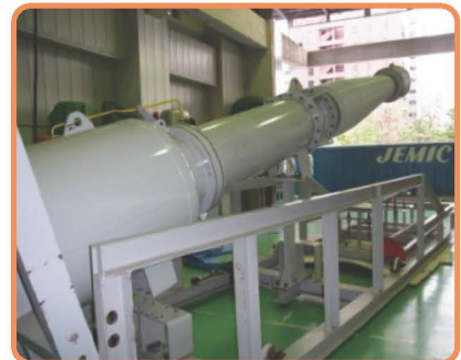
計器用変圧器
