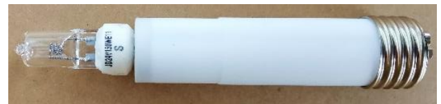
図 2 光源を E11/E26 変換ソケットに取り付けた状態
